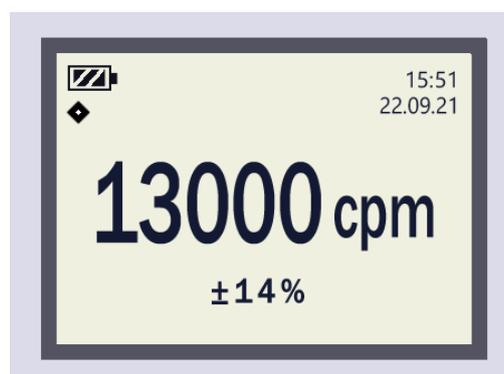
3. カウントモードが開始されたら、測定する表面から 15mm (誤差±3mm)の距離で測定器を固定してください。
