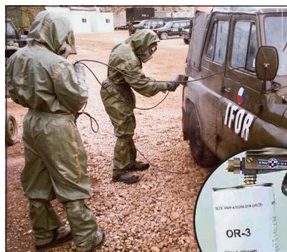
多価除染混合物 OR-3 は、武器および装甲戦闘車両の除染剤です。通常は噴霧して適用されます。OR-3 は、エタノールアミン、シクロヘキシルアミン、カリウムエトキシドを含む溶液です。
