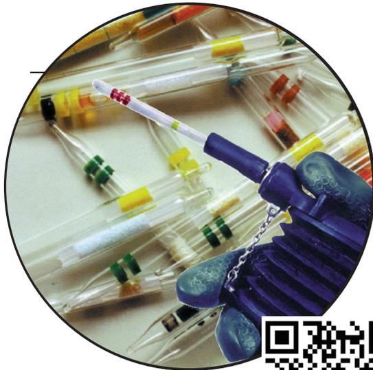
主要な化学剤をカバーできる 23 種類の検知管セットです。薬剤の入った検知管にポンプで空気を送り込むことで検出します。
