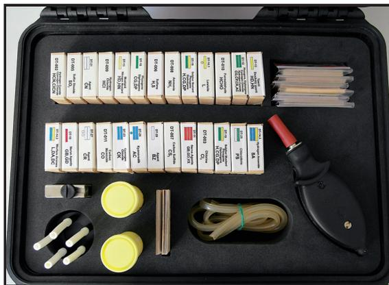
このセットは軍隊、消防隊、救助隊による偵察目的で使用されます。反応による色の変化によって視覚的に検出や濃度を評価して、空気、水、地形、機器表面上の CWA および TIC の存在を検出するように設計されています。
