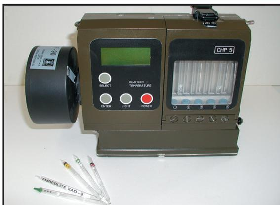
検知管のためのポンプです。バッテリー式で手持ちで利用、車両外部とホース接続して連続給電での利用。
