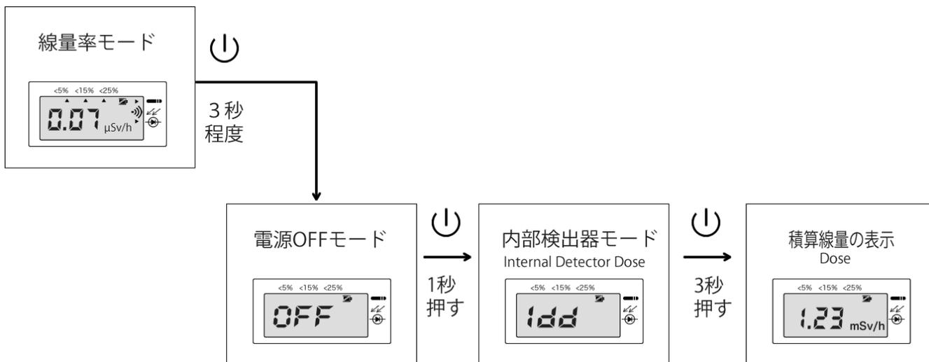
積算線量モードから、線量率モードへ戻るには、⏻ボタンを押すとすぐに戻れます。
